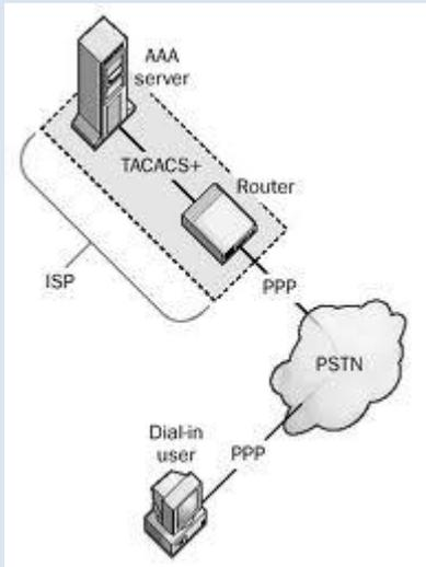
**TACACS+** (acrónimo de **Terminal Access Controller Access Control System**, en inglés ‘sistema de control de acceso del controlador de acceso a terminales’) es un protocolo de autenticación remota que se usa para gestionar el acceso (proporciona servicios separados de autenticación, autorización y registro) a servidores y dispositivos de comunicaciones.
