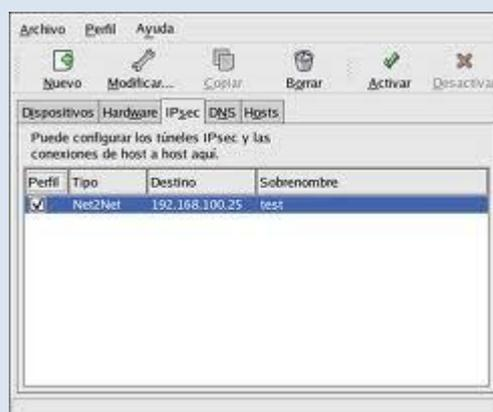
**IPsec** está implementado por un conjunto de protocolos criptográficos para (1) asegurar el flujo de paquetes, (2) garantizar la autenticación mutua y (3) establecer parámetros criptográficos.
