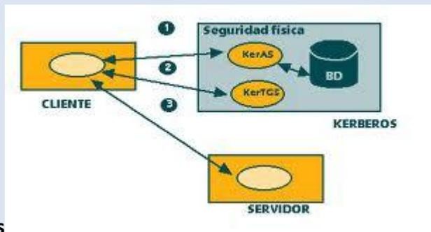
**Kerberos** es un protocolo de autenticación de redes de ordenador que permite a dos computadores en una red insegura demostrar su identidad mutuamente de manera segura. Sus diseñadores se concentraron primeramente en un modelo de cliente-servidor, y brinda autenticación mutua: tanto cliente como servidor verifican la identidad uno del otro. Los mensajes de autenticación están protegidos para evitar eavesdropping y ataques de Replay.
